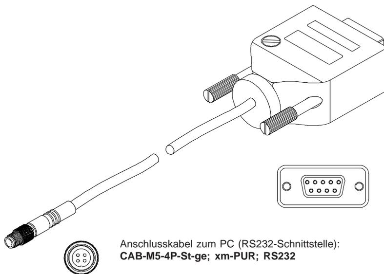
Anschlusskabel zum PC (RS232-Schnittstelle):
