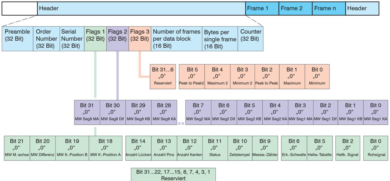
Abb. 83 Beispiel für eine Datenübertragung mit Ethernet
