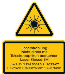
Abb. 1 Laserwarnschild und Laserhinweisschild
