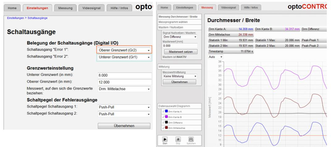
Abb. 57 Verwendung der Grenzwerte für die Messung
