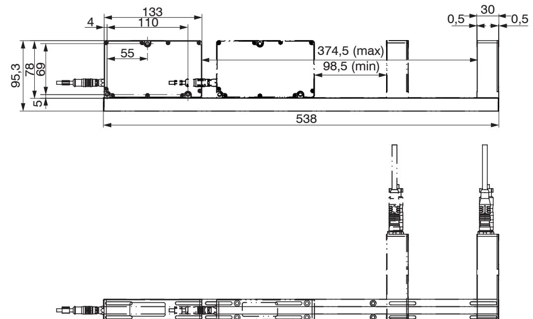
Abb. 12 Lichtquelle und Empfänger optoCONTROL 2520-46(090) mit Montageschiene, Abmessungen in mm
