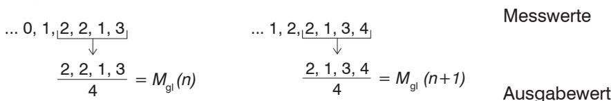
**i** Bei der gleitenden Mittelung im Sensor sind für die Mittelungszahl  $N$  nur die Potenzen von 2 zugelassen. Die größte Mittelungszahl ist 128.
