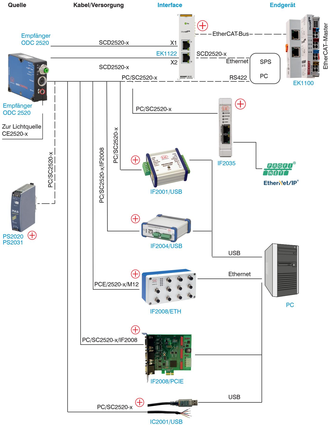
⊕ Sensorversorgung erfolgt durch Peripheriegerät.
