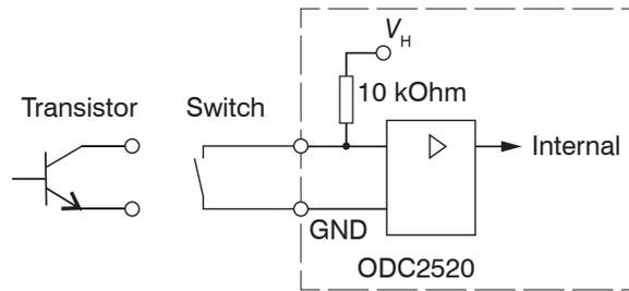
Abb. 26 Beschaltung des Schalteingangs (schematisch)
