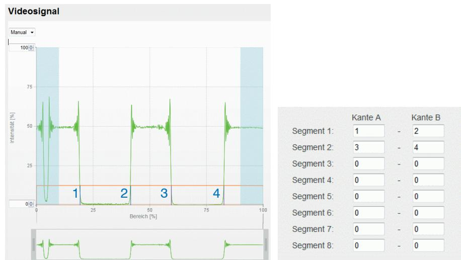
Abb. 33 Videosignal mit definierten Segmenten
