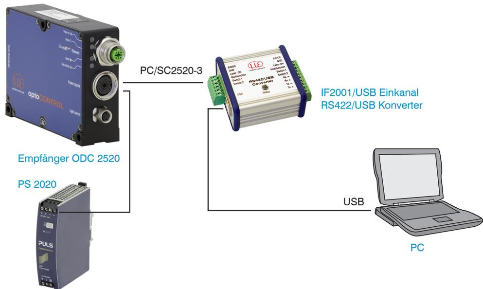
Abb. 80 USB-Anbindung an PC, Beispiel optoCONTROL 2520-46
