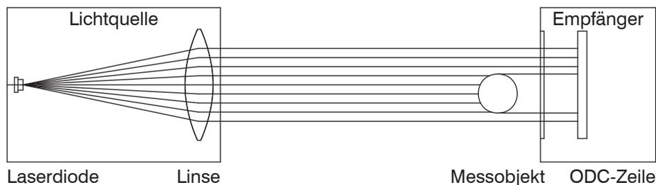
Abb. 4 Messprinzip optoCONTROL 2520
