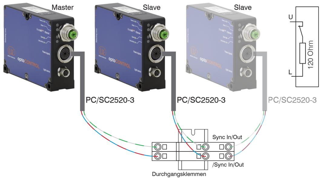
Abb. 64 Synchronisation mehrerer Sensoren, Beispiel optoCONTROL 2520-46
