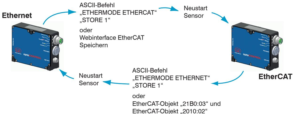
Die RS422-Schnittstelle für das Senden eines ASCII-Befehls ist sowohl im Ethernet-Mode als auch im EtherCAT-Mode verfügbar.
