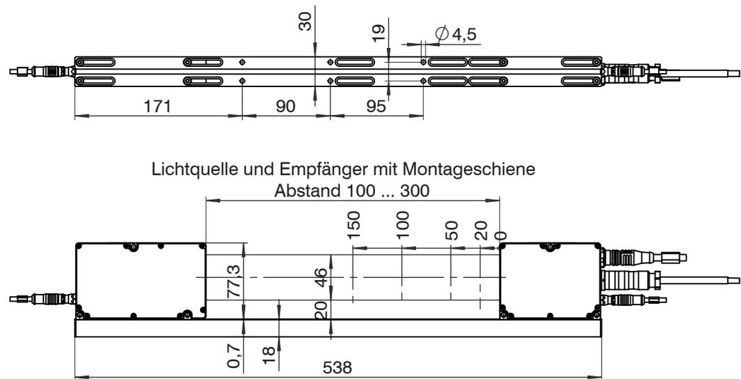
Abb. 11 Lichtquelle und Empfänger optoCONTROL 2520-46 mit Montageschiene, Abmessungen in mm
