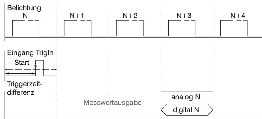
Abb. 69 Zeitverhalten bei Triggerung, steigende Flanke, eine Messwertausgabe
