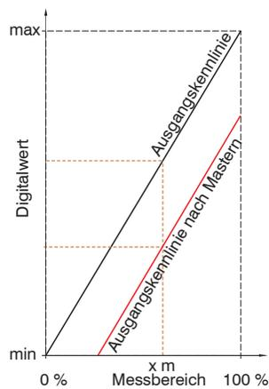
Abb. 53 Kennlinienverschiebung beim Mastern
