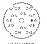
Ansicht: Lötseite, 12-pol. Kabelbuchse
