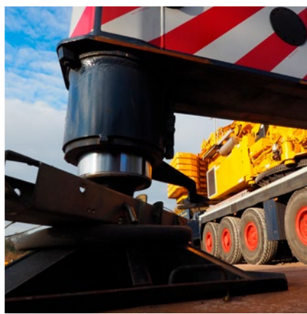
Variable Abstützung bei Fahrzeugkränen
