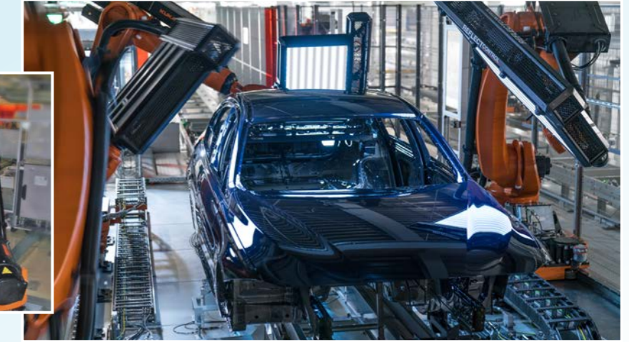
Heute werden reflectCONTROL Systeme von führenden Automobilherstellern eingesetzt, um Defekte auf Karosserien vollautomatisch zu erkennen.
