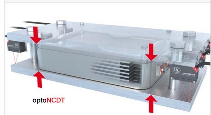
Um den kritischen Punkt vor dem Aufreißen zu detektieren und den Ladevorgang rechtzeitig unterbrechen zu können, wird die vertikale Ausdehnung in mehreren Lade- und Entladezyklen erfasst. Kompakte Laser-Sensoren übernehmen diese Aufgabe. Sie lassen sich auch bei beengten Raumsituationen integrieren und liefern eine hohe Messgenauigkeit.
