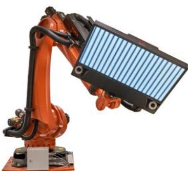
3D-Sensoren am Roboter zur Lackfehlerkontrolle / AOI in der Automotive-Fertigung
