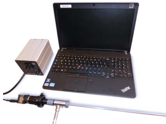
Abb. 15 Endmontage Endoskop mit USB-Kamera, Laptop und Lichtquelle
