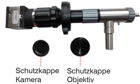
Abb. 13 Endmontage Kamera / Objektiv mit Schnellverschluss und Endoskop
