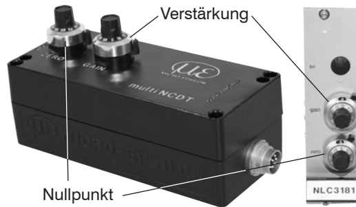
Abb. 14 Potentiometer für die Kalibrierung
