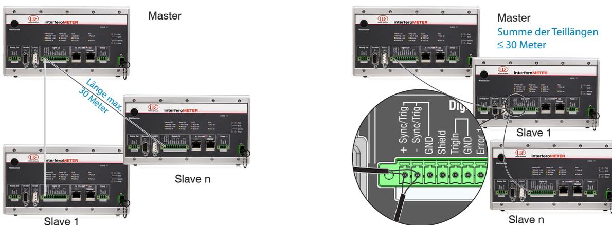
Abb. 19 Synchronisierung mehrerer Controller, links sternförmig, rechts verkettet
