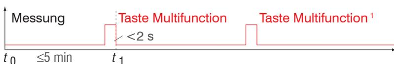
Abb. 64 Ablaufdiagramm für Nullsetzen, Mastern (Taste Multifunction)
