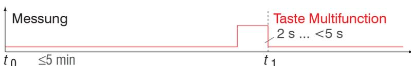
Abb. 65 Ablaufdiagramm für die Rücknahme Nullsetzen, Mastern
