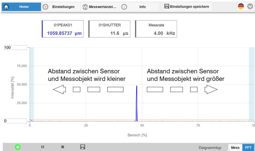
Abb. 33 Einsatz des FFT-Signals zur Positionierung des Sensors
