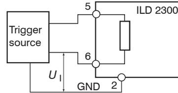
Fig. 42 Trigger wiring
