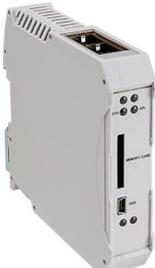
A white industrial gateway device with a vertical orientation, featuring an Ethernet port and several status LEDs. | <p>Das 2D/3D Gateway kommuniziert mit dem scanCONTROL SMART Sensor über Ethernet Modbus und übersetzt dessen Ergebniswerte in die Feldbussysteme PROFINET, EtherCAT oder EtherNet/IP. Optional kann das Gateway werksseitig vorparametriert werden.</p> |
