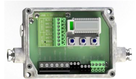
Abb. 10 Geöffneter Controller mit Anschlussklemmen
