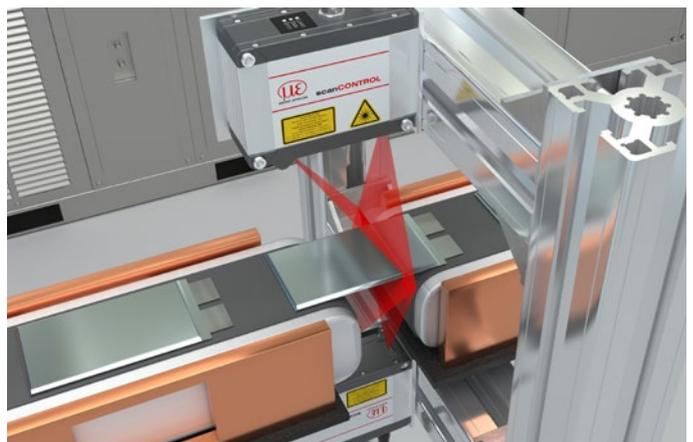
Prüfung von Pouchzellen
