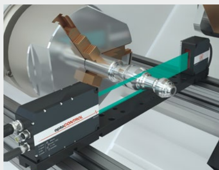
Inline Konturmessung von Drehteilen
