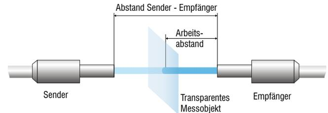
Transmissionssensor bestehend aus Sender und Empfänger
