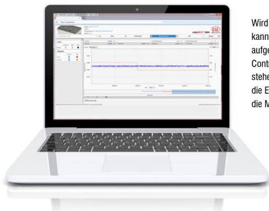
Wird ein PC über die Ethernet-Schnittstelle verbunden, kann ohne weitere Installation ein modernes Webinterface aufgerufen werden, das die Parametrierung von Sensor und Controller ermöglicht. In der Controllerausführung DT3061 stehen erweiterte Funktionen wie die 5-Punkt-Kalibrierung, die Einstellung von Schalt- und Temperaturschaltgängen und die Mehrfachkennlinienspeicherung zur Verfügung.
