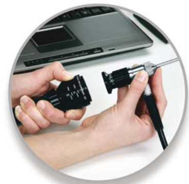
Anschluss Kamera mit Objektiv an ein Endoskop
