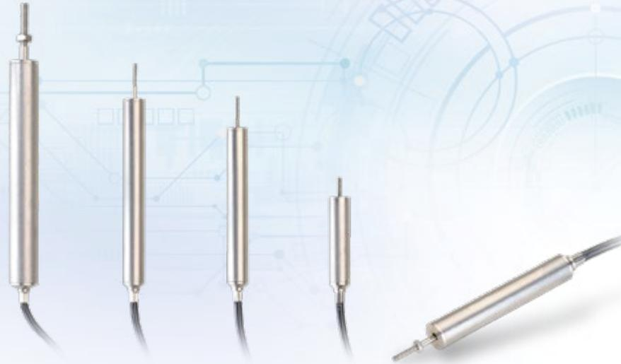
LVDT Wegsensoren haben einen frei im Sensorgehäuse beweglichen Stößel. Zur Übertragung einer Messobjektbewegung wird der Stößel über ein Gewinde mit dem Objekt verbunden. Der Messvorgang im Sensor erfolgt berührungslos und damit verschleißfrei.
