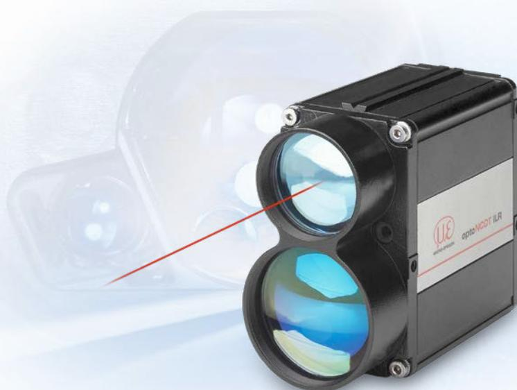
Sensoren der Serie optoNCDT ILR 1191 sind optoelektronische Sensoren für berührungslose Abstands-, Distanz- und Geschwindigkeitsmessungen im industriellen Einsatz. Der Sensor ist für enorme Messweiten mit und ohne Reflektor konzipiert. Durch die sehr hohe Messrate können bewegte Objekte leicht erfasst werden. Dieser Sensor arbeitet nach dem Laser-Laufzeit-Verfahren und ist deshalb insbe-
