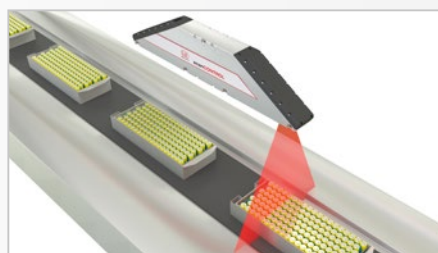
Montageüberwachung von Batteriepaketen
