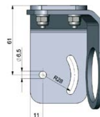
TM-AB-CTL Equerre de montage (ajustable)
