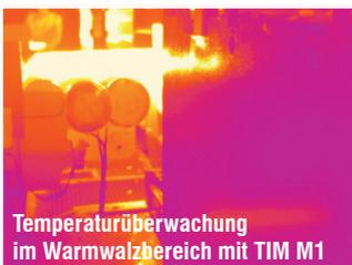
Temperaturüberwachung im Warmwalzbereich mit TIM M1
