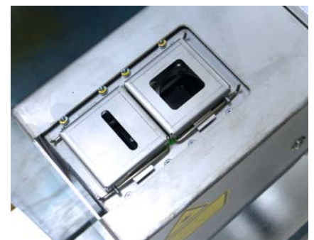
Pneumatische Schutzeinrichtung, gegen Verschmutzung der Optik
