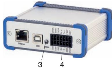
*Abb. 7 Steckerbelegung Stiftleiste 14-polig (4), Typ WAGO mit Ansicht auf Pin Laser*
