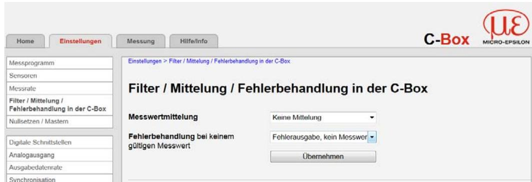
Es stehen mehrere Filtertypen für die Messwerte zur Verfügung. Eine Filterung vermindert das Rauschen des Messsignals und sorgt somit für eine bessere Auflösung. Über die Filterbreite wird die Anzahl der Messwerte, auf die der Filter wirkt, eingestellt.
