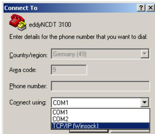
Mit dem Standardprogramm HyperTerminal® können Sie Daten über die Ethernet-Schnittstelle empfangen und den Controller konfigurieren. Sie benötigen dazu lediglich eine freie Ethernet-Schnittstelle an Ihrem PC und die beschriebenen Steuerkommandos, siehe Kap. A 2.
