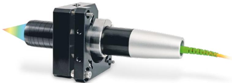
Insbesondere bei hochauflösenden Sensoren mit geringem Verkipfungswinkel wird eine orthogonale Befestigung vorausgesetzt. Der Montageadapter JMA-xx ermöglicht über den einfachen Verstellmechanismus die Feinausrichtung des Sensors auf das Messobjekt. Damit können geringfügige Montageabweichungen oder Schräglagen des Messobjekts einfach ausgeglichen werden.
