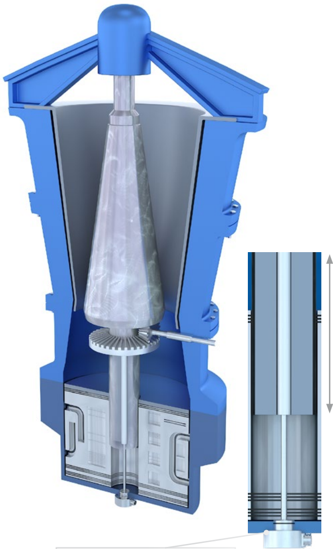
EDS-F: Messung des Mahlsalts in Gesteinsbrechern
