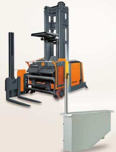
Seilzugsensoren erfassen die Hubhöhe in Gabelstaplern
