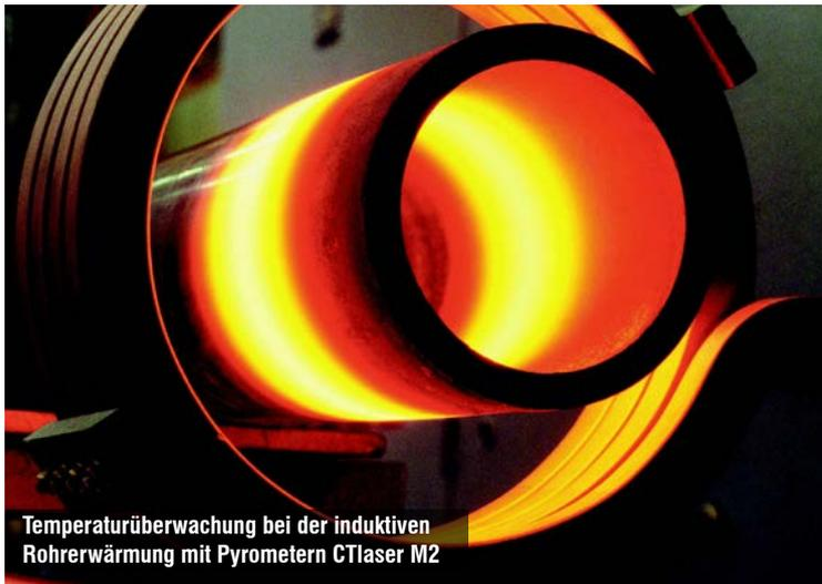
Temperaturüberwachung bei der induktiven Rohrerwärmung mit Pyrometern CTlaser M2
