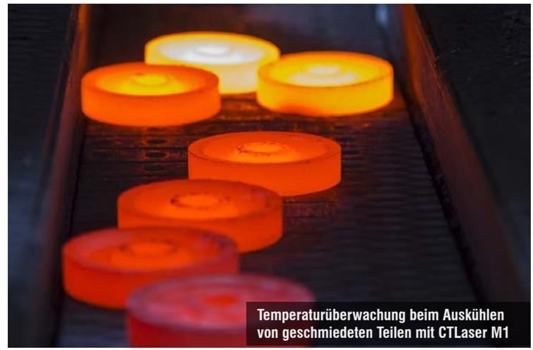
Temperaturüberwachung beim Auskühlen
