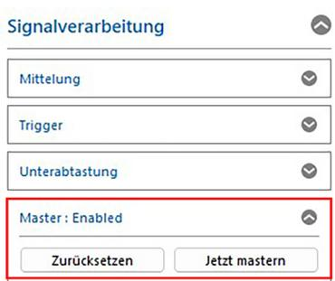
Mit dem Button `Zurücksetzen` wird der hinterlegte Masterwert entfernt.
