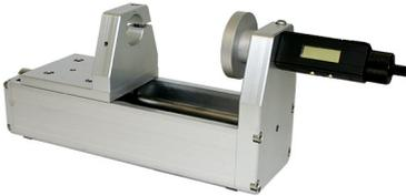
Digitale Mikrometerkalibriervorrichtung, Einstellbereich 0 - 25 mm, verstellbarer Nullpunkt für alle Sensoren
