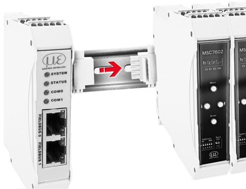
Abb. 6 Anschluss einer MSC7602 mit MSC7602-Steckersatz IF2035-PROFINET
