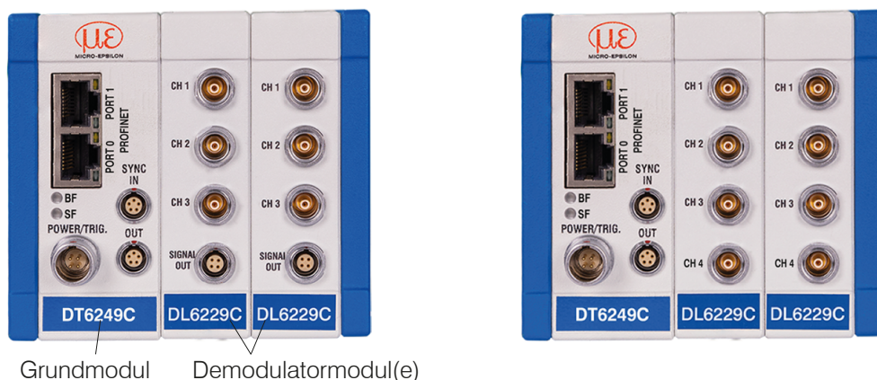
Abb. 2.3: Frontansicht Grundmodul DT6249C und Demodulatormodul DL6229C mit bis zu 6 Kanälen (links) bzw. bis zu 8 Kanälen (rechts)
