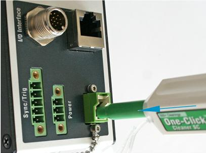
Abb. 82 One-Click™ Cleaner zum Reinigen von E2000-Lichtwellenleiterübergängen
