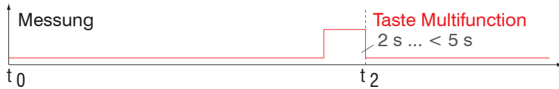
Abb. 6.20: Ablaufdiagramm für die Rücknahme Nullsetzen, Mastern
