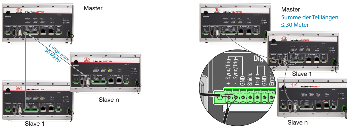
Abb. 19 Synchronisierung mehrerer Controller, links sternförmig, rechts verkettet
