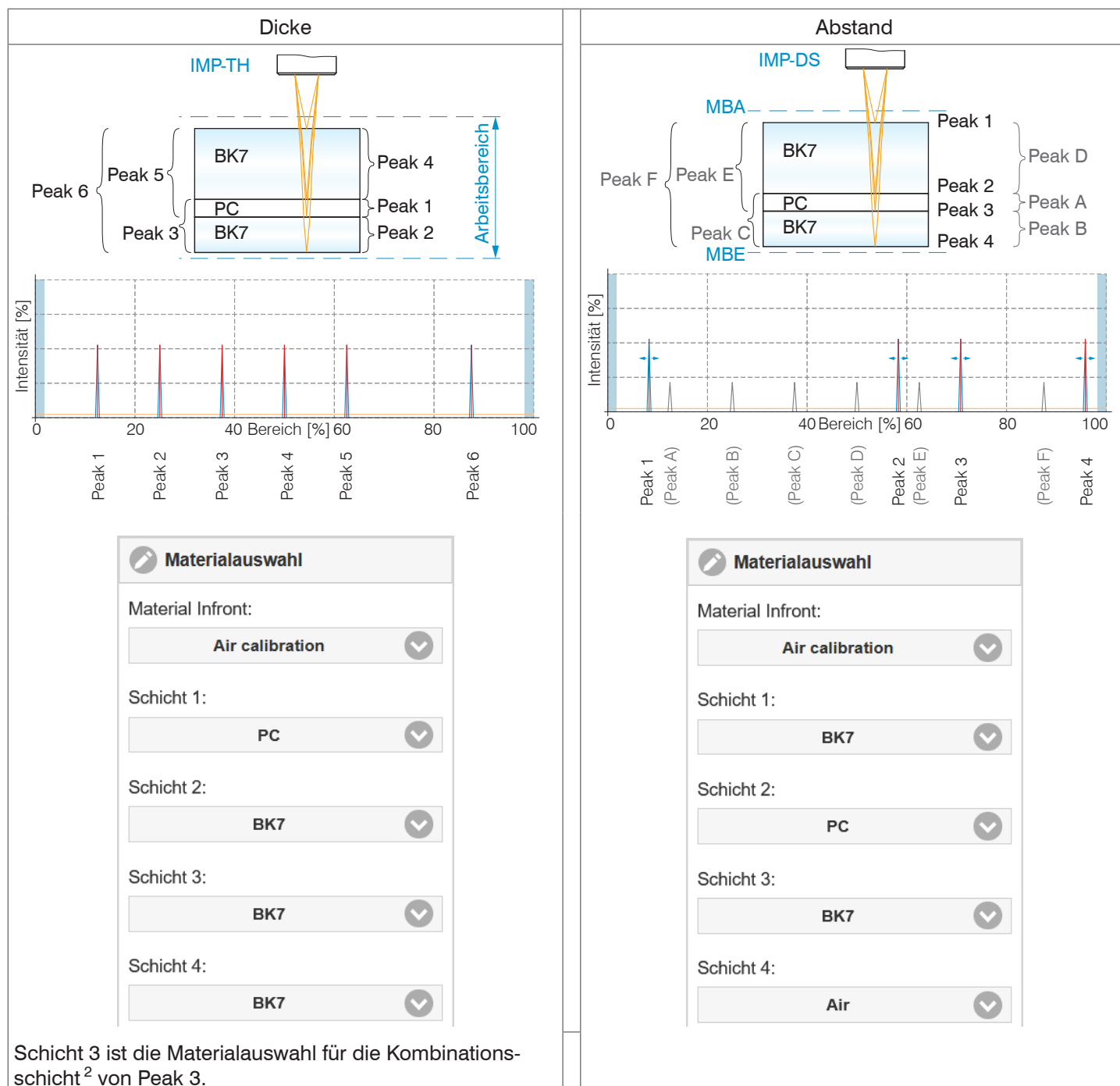
Abb. 48 Messanordnung aus drei Schichten mit zugehöriger Materialauswahl
