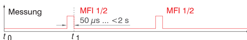
Abb. 6.17: Ablaufdiagramm für Nullsetzen, Mastern (Multifunction-Taste)
