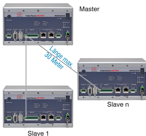
Abb. 4.10: Synchronisierung mehrerer Controller, sternförmig
