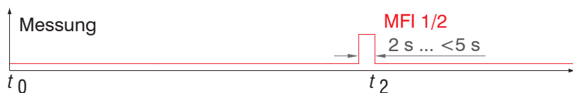
Abb. 6.18: Ablaufdiagramm für die Rücknahme Nullsetzen/Mastern (Multifunction-Taste)
