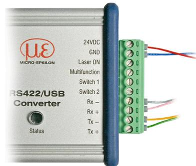
Tab. 4.9: Anschluss Sensor am Konverter IF2001/USB
