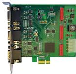
Interfacekarte IF2008/PCIE für die synchrone Erfassung von 4 digitalen Sensorsignalen oder 2 Encoder. In Verbindung mit IF2008E können insgesamt 6 digitale Sensor-Signale, 2 Encoder, 2 analoge Signale und 8 I/O Signale synchron erfasst werden.
