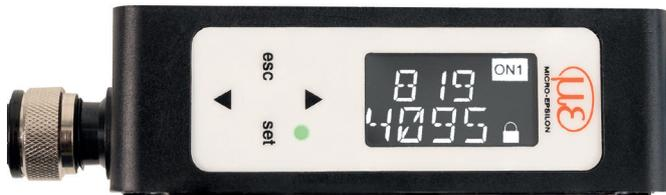
Der Controller verfügt neben der LED auch über eine Display-Anzeige und eine Folientastatur, [siehe 4.4](#), über die der Controller bedient wird.
