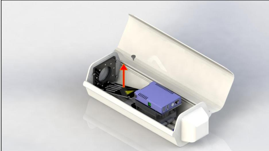
**Abbildung 11:** Befestigungsblech entfernen
