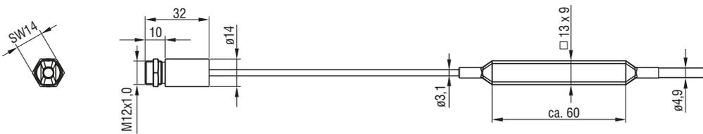
Abb. 5.1: Maßzeichnung thermoMETER SE-SF15-S05-C05, Abmessungen in mm
