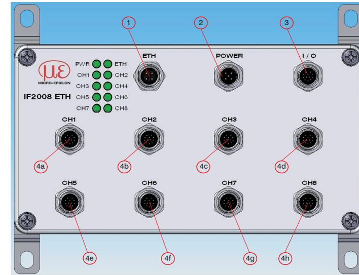
Steckverbindungen IF2008 ETH Schnittstellenmodul
