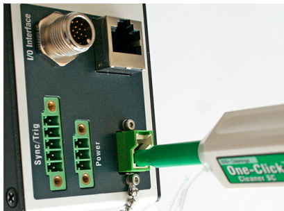
Abb. 11 One-Click™ Cleaner zum Reinigen von E2000-Lichtwellenleiterübergängen
