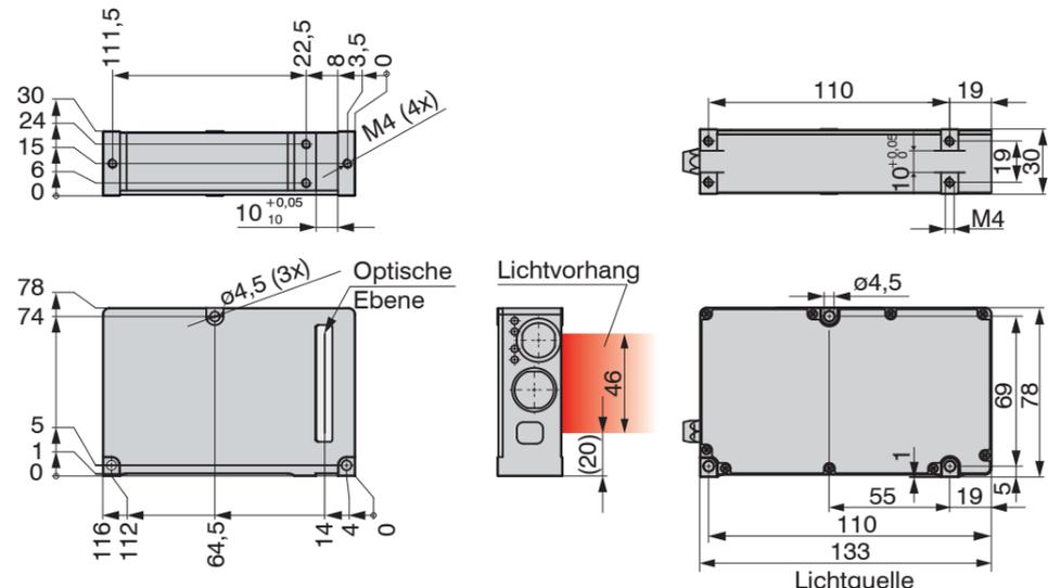
Abb. 1 Maßzeichnung ODC 2520-46(090) Lichtquelle und Empfänger, Abmessungen in mm
