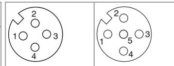
**4-pol. Kabelbuchse M12 für Versorgung und Signale, A-codiert, ungeschirmt und offene Enden, Ansicht Lötseite**
