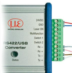
Symmetrische Differenzsignale nach EIA-422, nicht galvanisch von der Spannungsversorgung getrennt. Verwenden Sie ein geschirmtes Kabel mit verdrehten Adern, z. B. PC3800-x. Die RS422-Schnittstelle kann sowohl zur Konfiguration als auch zur permanenten Datenübertragung, auch über größere Entfernungen, genutzt werden.
