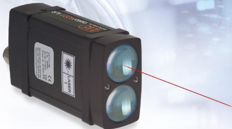
Der optoNCDT ILR1171 ist ein laserbasierter Distanzsensor für berührungslose und präzise Abstands- und Wegmessungen von 0,2 m bis zu 125 m. Mit einer Reflektorfolie kann der Messbereich auf 270 m erweitert werden. Der Sensor ist für enorme Messweiten mit und ohne Reflektor konzipiert. Durch die sehr hohe Messrate können bewegte Objekte leicht erfasst werden. Auch bei schlechten Sichtverhältnissen überzeugt der ILR1171-125 mit einer hohen Signalintensität für stabile Messungen.
