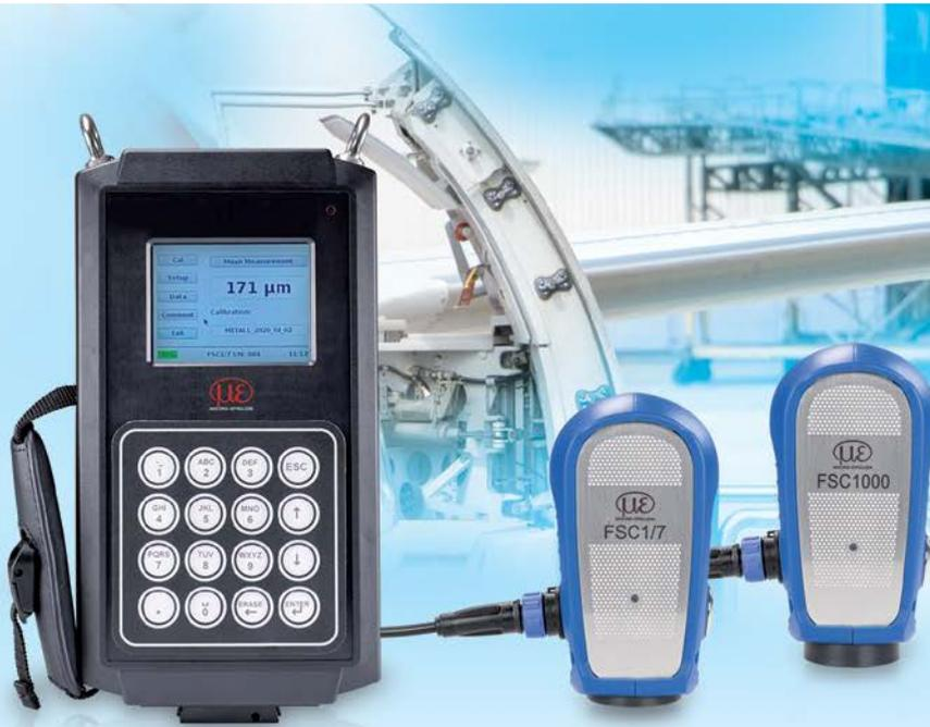
Zerstörungsfreie Messung auf CFK,
