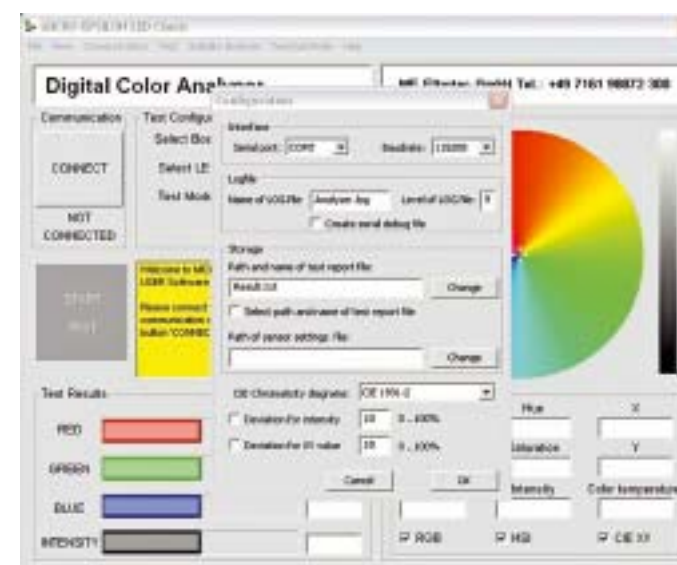
Die Software zum Sensor dient zur Datenprotokollierung und Konfiguration des Sensors
