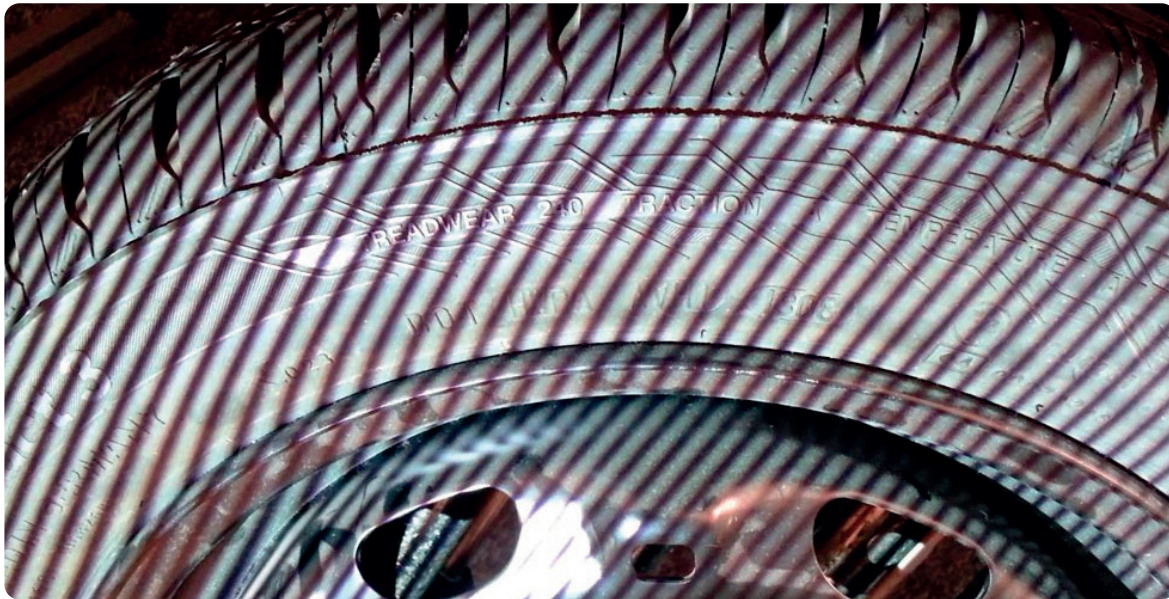
Bild 2: Das System arbeitet auf Basis der Streifenlichtprojektion. Dabei werden sequentiell Muster auf die Seitenwand des Reifens projiziert und mit einer Kamera erfasst.
