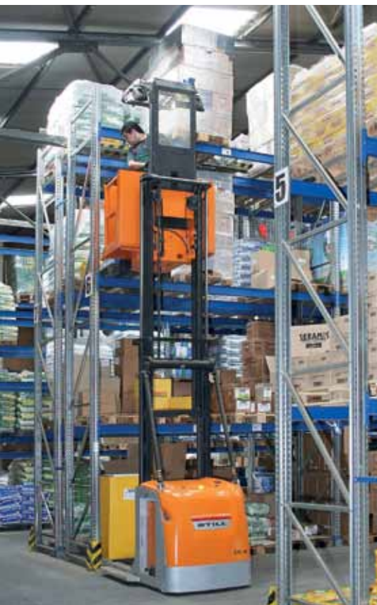
2: In Kommissionierstaplern messen Seilzugsensoren die Höhe der Gabel und ermöglichen damit indirekt eine schnellere Logistik
